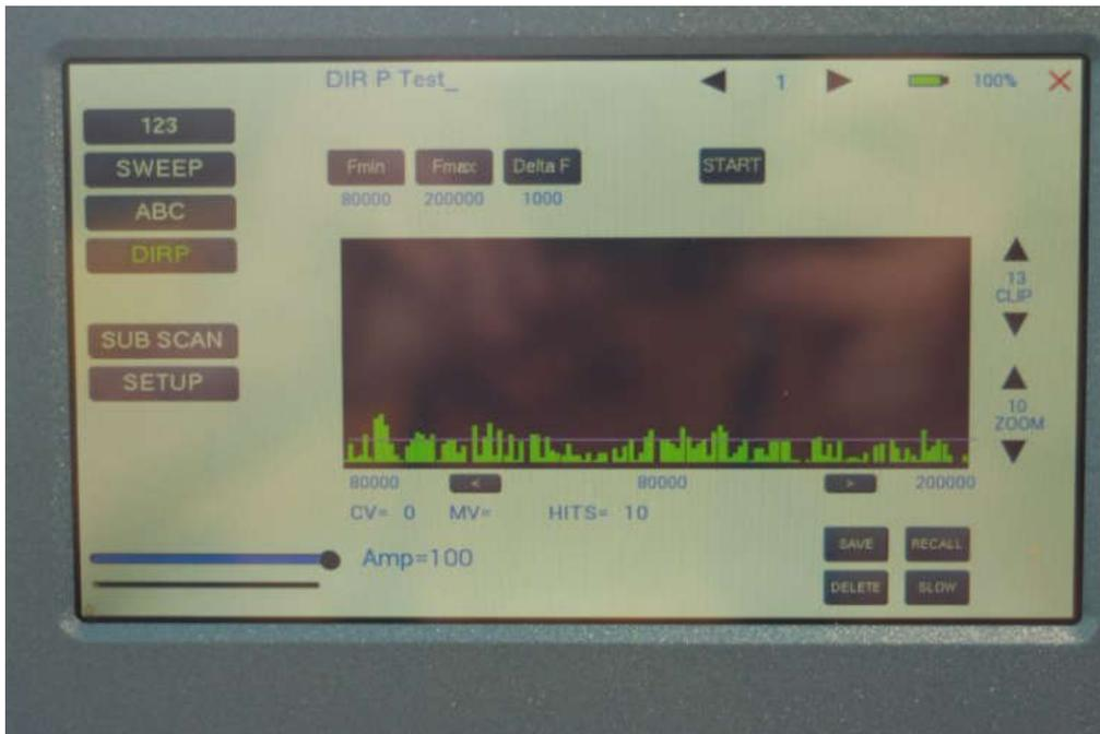
Der abgebildete Bildschirm zeigt alle Details einer Analyse, darunter die Einstellungen für "Fmin", "Fmax", "DELTA F" und für den Clipping Level "CL = 13" (die violette Linie), sodass 10 HITS (gemessene Werte von Resonanzen) entstehen.
