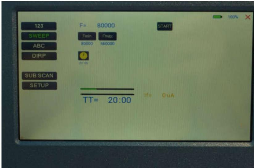
SWEEP wird verwendet, um einen grossen Frequenzbereich zwischen den Grenzen Fmin und Fmax „abzufahren“. Die Grenzen Fmin und Fmax sind einstellbar. Die Schrittweite DELTA F berechnet sich für SWEEP immer automatisch.
