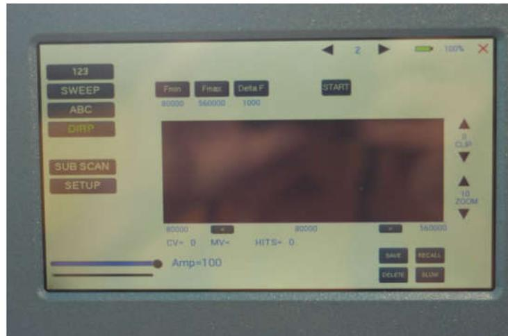
DIRP ist ein Resonanz-analyse-Verfahren. In dem Frequenzbereich FMIN bis FMAX werden in den Schritten DELTAF Resonanzen erfasst.
